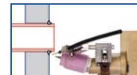
Schweißen von überstehenden Rohren
