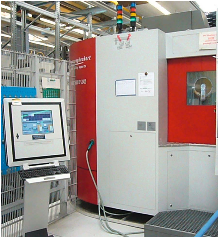
Effizient platzierter Leitrechner zwischen der Rüststation und dem ersten Bearbeitungszentrum.
