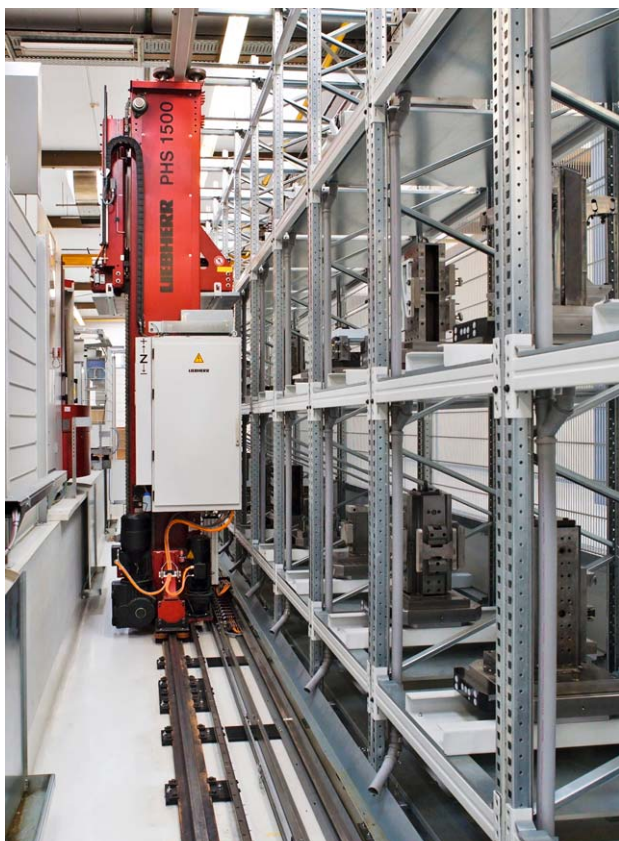
Regalfahrzeug zur automatischen Handhabung der bestückten Maschinenpaletten. Gut erkennbar das tief gesetzte Palettenregal und die unteren Führungsschienen für das Regalfahrzeug.
