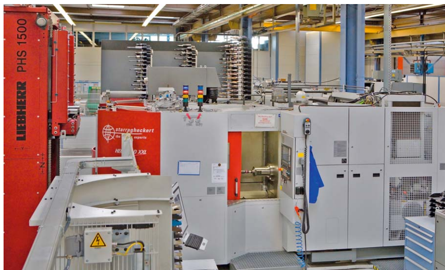
StarragHeckert-Bearbeitungszentrum HEC 500 D XXL mit dem Palettenhandhabungssystem PHS 1500 von Liebherr.
