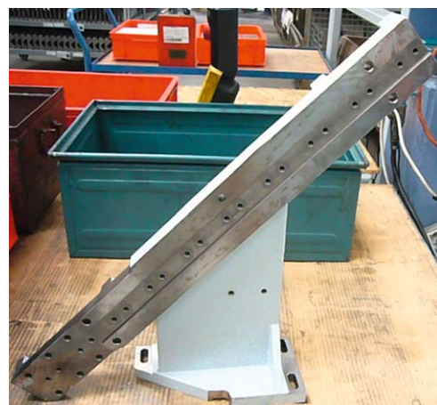
Fertig bearbeitete Oberdruckaufnahme für eine Kantenanleimmaschine aus der KD-400er-Baureihe.
