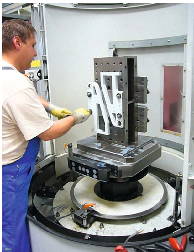
Die vorbereiteten Maschinenpaletten werden über den Rüstplatz ins Palettenhandhabungssystem eingeschleust.
