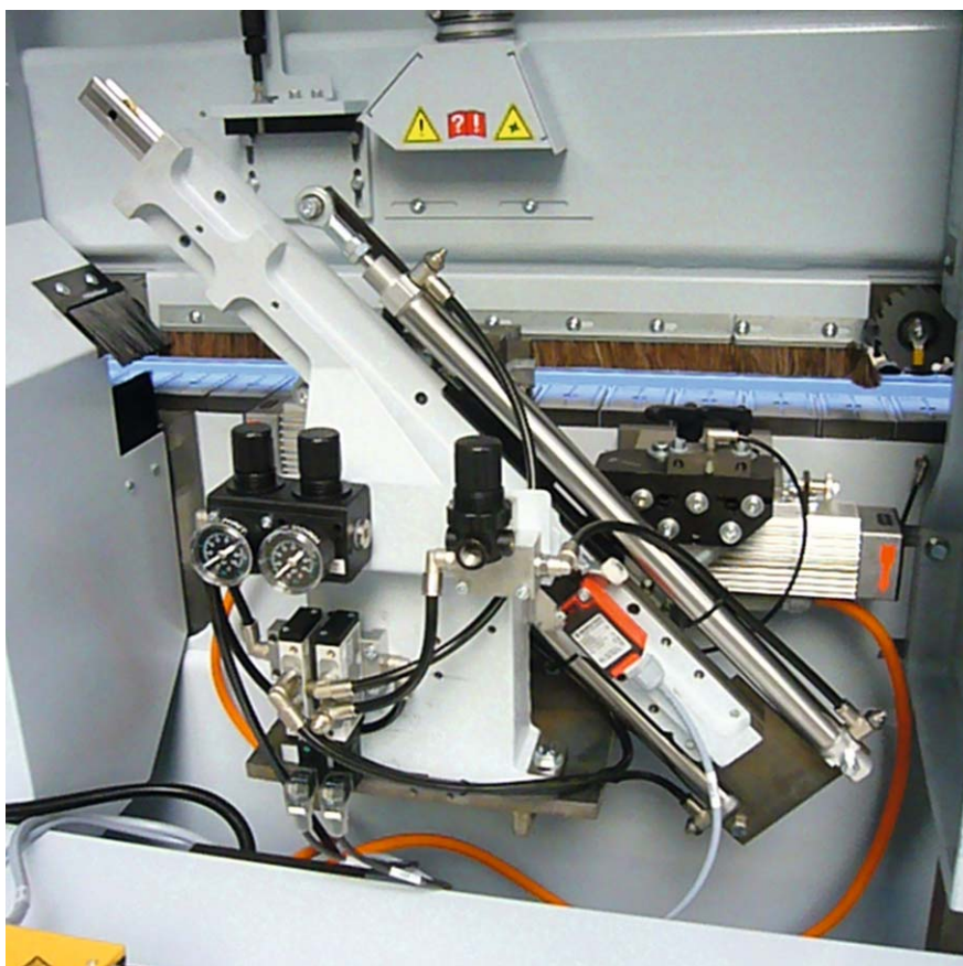
Blick auf das installierte Kappaggregat in einer KDF-420-Kantenanleimmaschine. Der Kappfuss wird auf den StarragHeckert-Bearbeitungszentren HEC 500 D XXL gefertigt.
