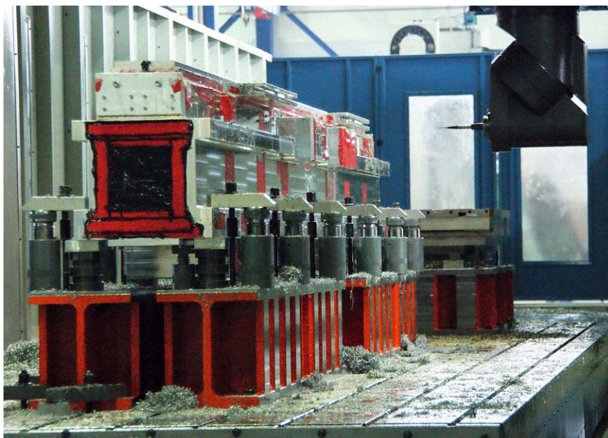
Hochpräzisionsbearbeitung eines Grossträgers für das Forschungsprojekt UE65 für den Elektronenspeicherring BESSY II.
