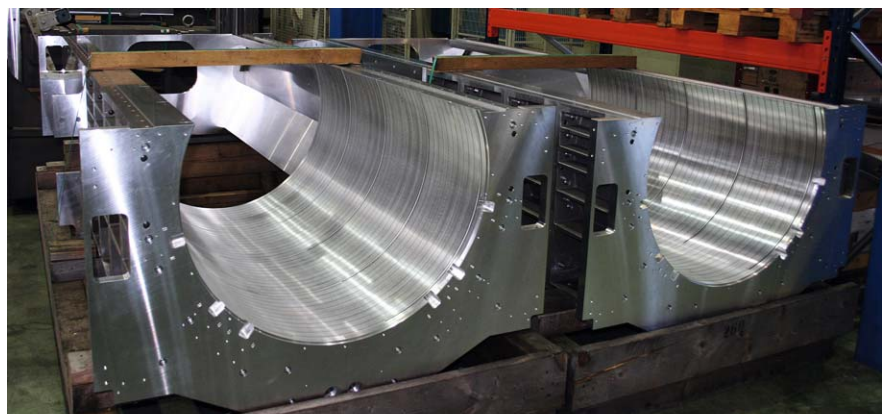
Beispiel für die Grossteilebearbeitung auf insgesamt sieben Fahrständer-Portalfräsmaschinen von Nicolas Correa mit Verfahrwegen von 2500 x 2000 x 800 mm bis 1400 x 1200 x 2500 mm (X, Y, Z).
