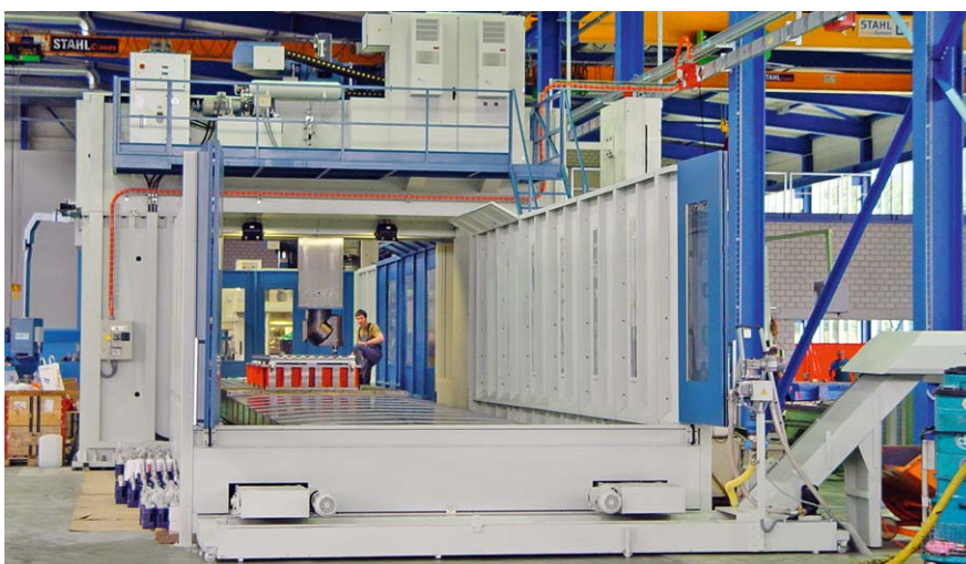
Die neue Grossteile-Portalfräsmaschine Nicolas Correa, Typ FP-50/100, mit Verfahrwegen von X = 10 000 mm, Y = 4500 mm und Z = 1500 mm in der neuen Fabrikhalle bei Bruhin & Diethelm. (Bild: B & D)
