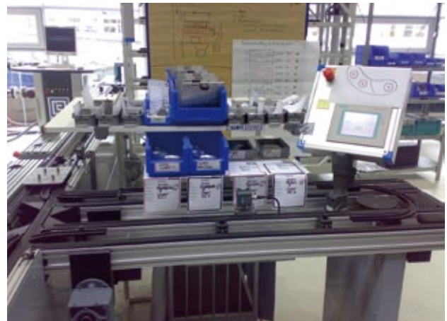
Die physische Modellfabrik mit dem iTRAME System (oben) ist direkt an die digitale Lerninsel (links) gekoppelt. Rechts ist ein Modul für die Montage des Beispielproduktes zu sehen.
