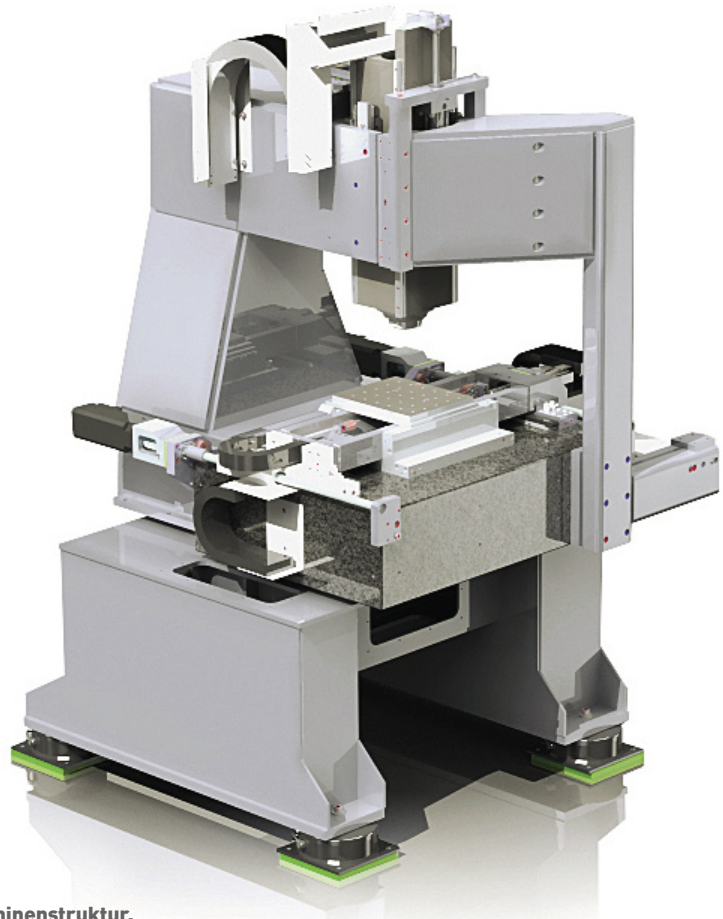
Die Maschinenstruktur. Deutlich erkennbar ist in der Bildmitte der flächig geführte Schlitten auf dem Granitbett.
