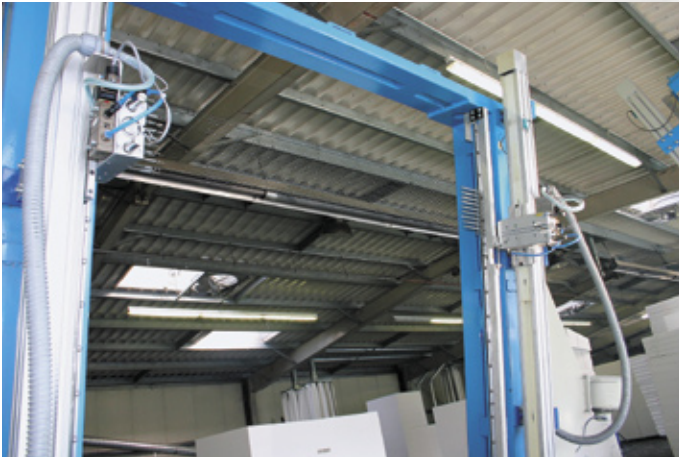
Kompletter Schneidrahmen, bestehend aus zwei INA-Linearmodulen MKUVE20-B-ZR mit jeweils einem Greifersystem und neun Einzeldrahteinheiten. Die Einzeldrähte werden abhängig von der Dachplattendicke positioniert.
