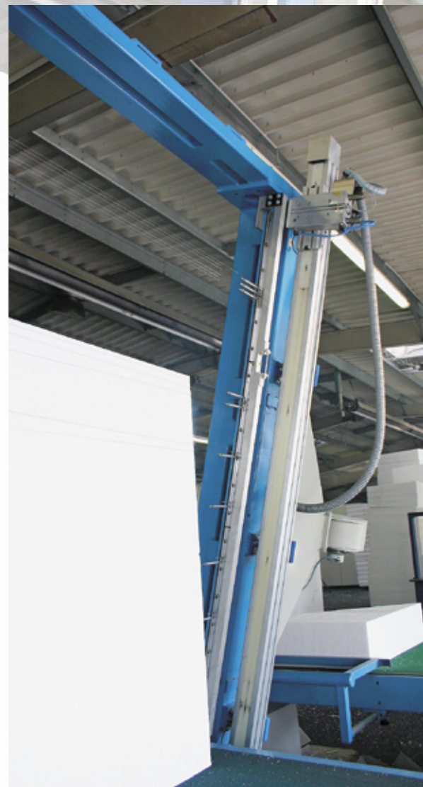
Eines (rechts) von zwei INA-Linearmodulen MKUVE20-B-ZR mit dem auf den Laufwagen montierten Greifer zum Verstellen und Positionieren der Einzeldrähte.
