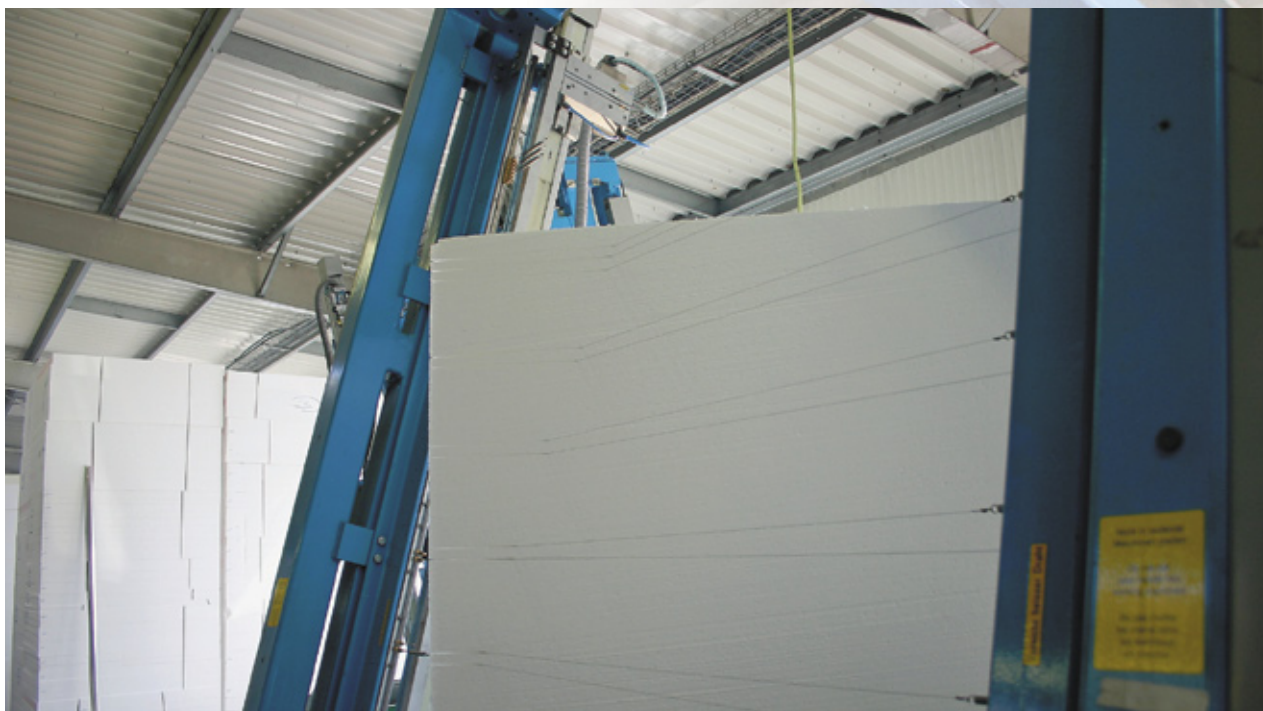
Materialsparendes Aufschneiden eines EPS-Blocks 3000 x 1200 x 1200 mm durch Heissdrahteinheiten, die exakt auf die jeweiligen Dachplattendicken eingestellt sind.
