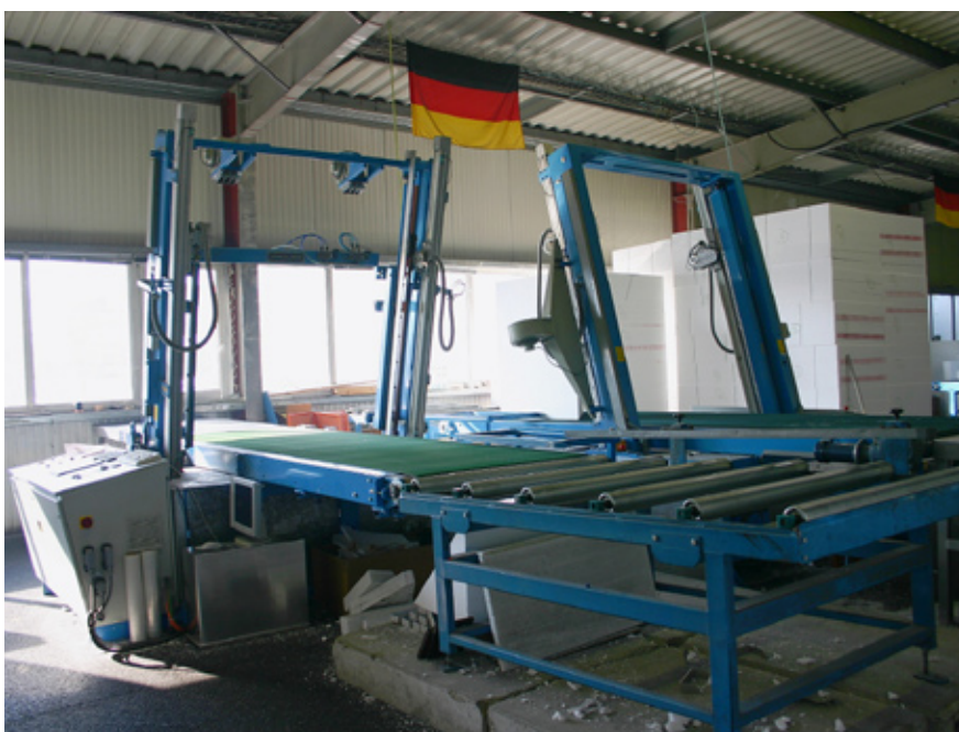
Zwei Komplettanlagen zum Schneiden von EPS-Blöcken der Dimensionen 3000 × 1200 × 1200 mm im Heissdrahtverfahren.
