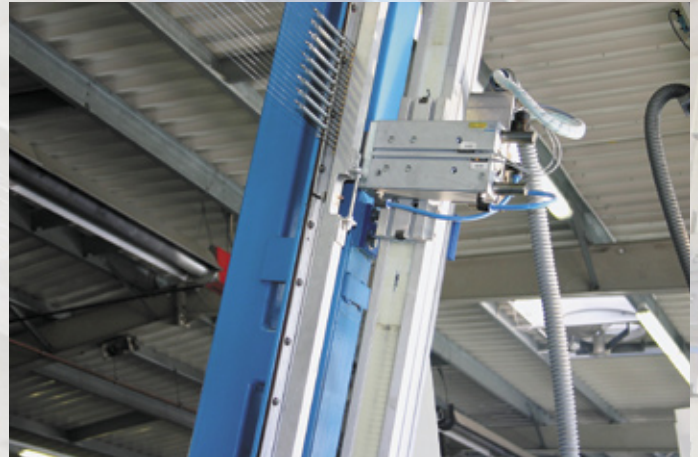
Installation des Greifers im Detail (rechts) auf dem Linear modul und Führungsschiene zur Aufnahme und zur Verstellung von insgesamt neun Heissdrahteinheiten.
