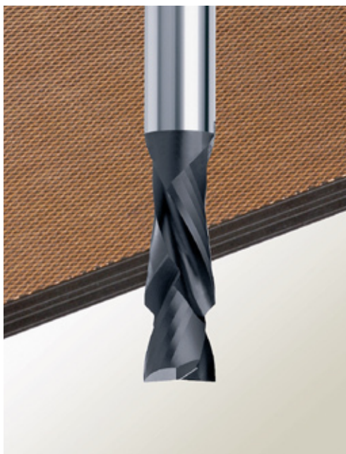
VHM-Fräser Baureihe Upcut/Downcut mit Diamantbeschichtung zum Kantenfräsen von kupferbeschichtetem CFK-Material.
