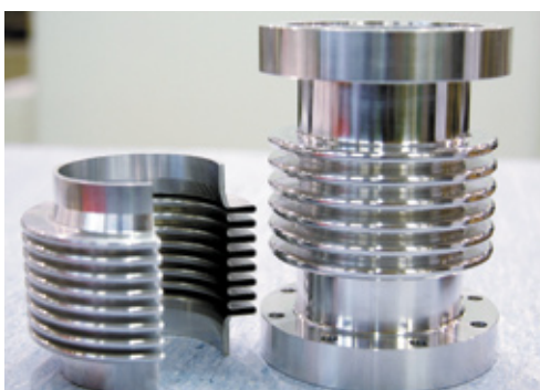
Mit CTX 510 eco am CERN leisten die Mitarbeiter inzwischen Überdurchschnittliches. Dieses Kuppelungsbauteil beispielsweise hat eine Wanddicke von lediglich 0,3 mm und wurde aus dem Volten gearbeitet.
