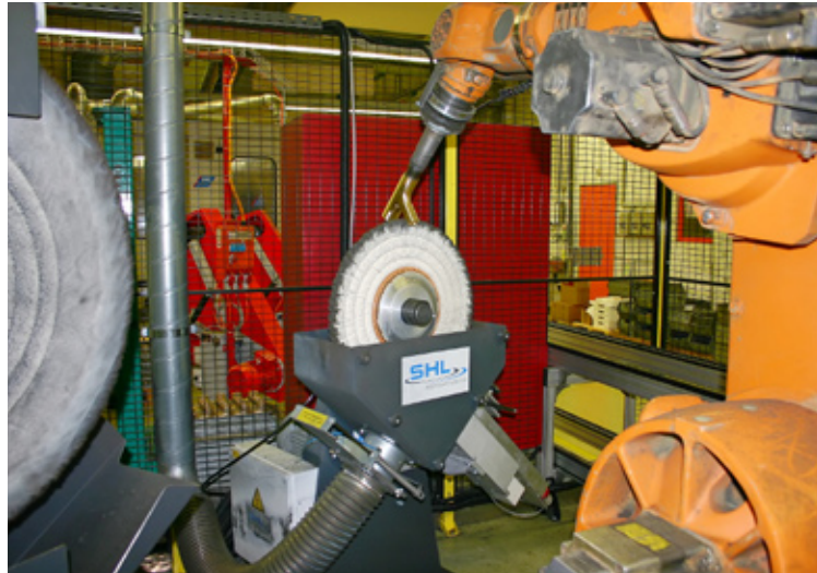
Bild 3 zeigt die Roboter-Polierbearbeitung von Armaturen auf einer von vier Polier- und Abglanzmaschinen in der gekapselten Roboter-Polierzelle.
