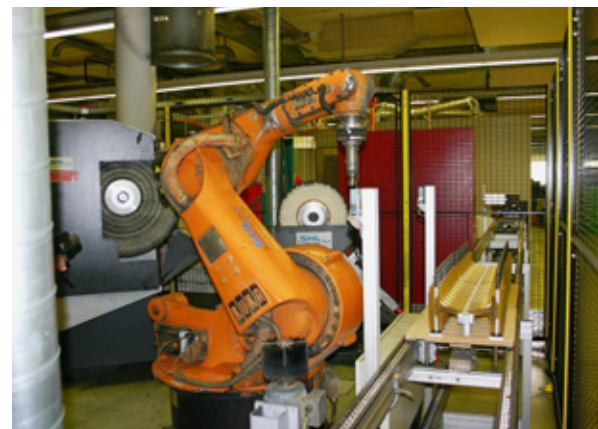
Bild 2 zeigt die Roboter-Polierzelle mit einem Teil der Poliermaschinen, dem Roboter mit (Wechsel)Greifer und aufgenommenem Werkstück sowie zwei Werkstückpaletten auf dem Paletten-Fördersystem.
