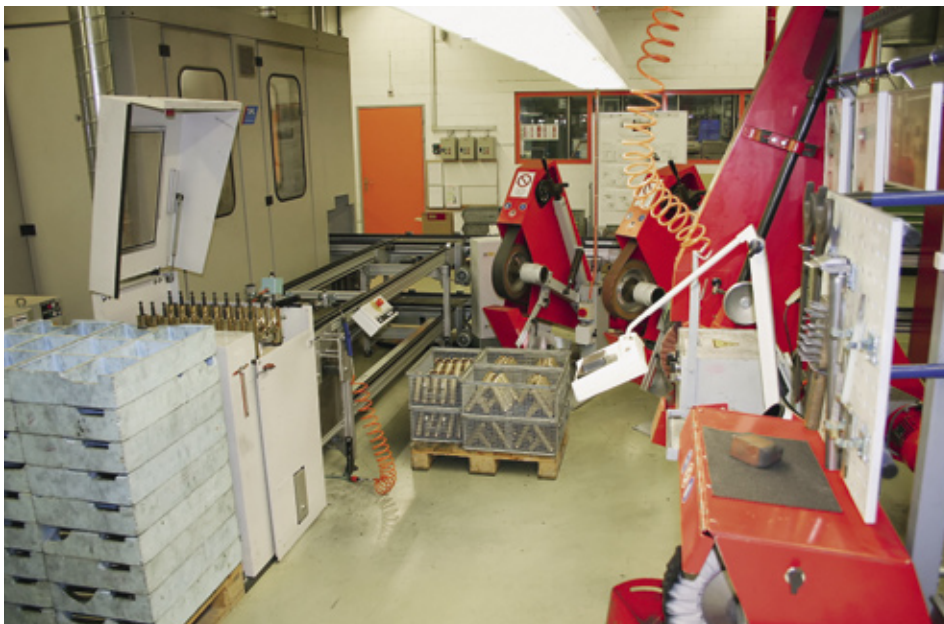
Bild 1 zeigt das «Handarbeitszentrum» der neuen Roboter-Schleif- und Polierzelle; links sind die Vollschutzverkleidung der Roboter-Schleifeinheit und daneben der Bestückungsplatz für die Palettenbeladung sowie das Paletten-Fördersystem zu sehen; in der Mitte dann mehrere manuelle Schleif- und Polierstationen für eventuelle Nacharbeiten; rechts befindet sich dann die Roboter-Polier-einheit mit Vollschutzkabine.
