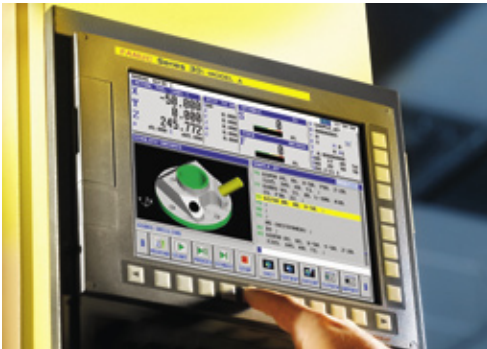
Die Prototypen- und Kleinserienfertigung fordert, dass die Programmierung einfach und schnell vonstatten geht. Unterstützung bietet die Werkstattprogrammiersoftware Manual Guide i.
