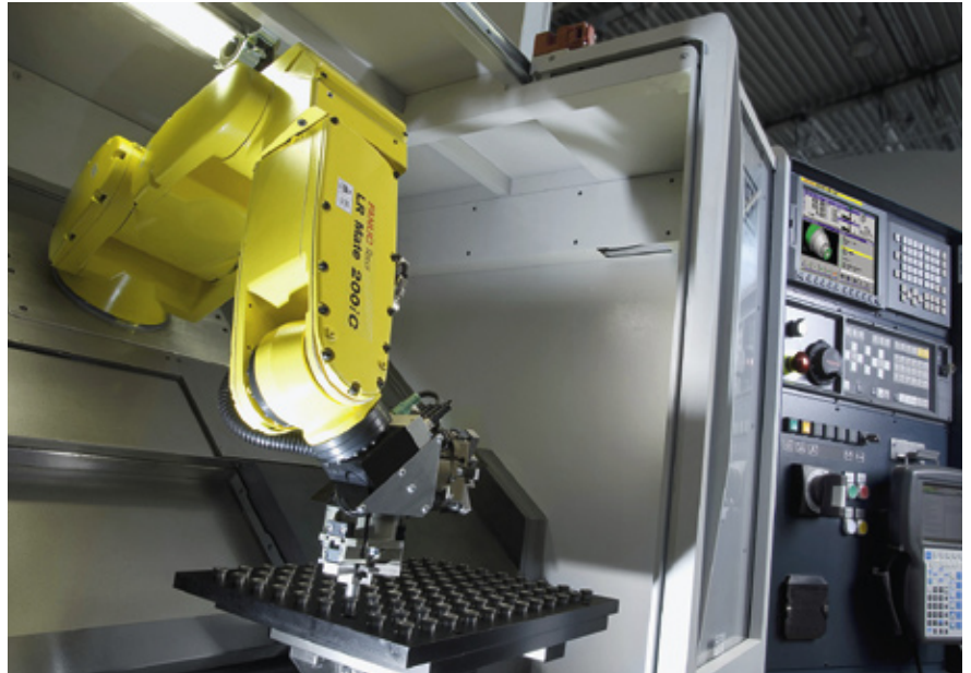
Eine wichtige Rolle in der Serienfertigung spielen ausserdem automatisierte Prozesse. Bauteilkontrolle, Nachbearbeitung und Abtransport werden in vielen Fällen Robotersystemen überlassen.
