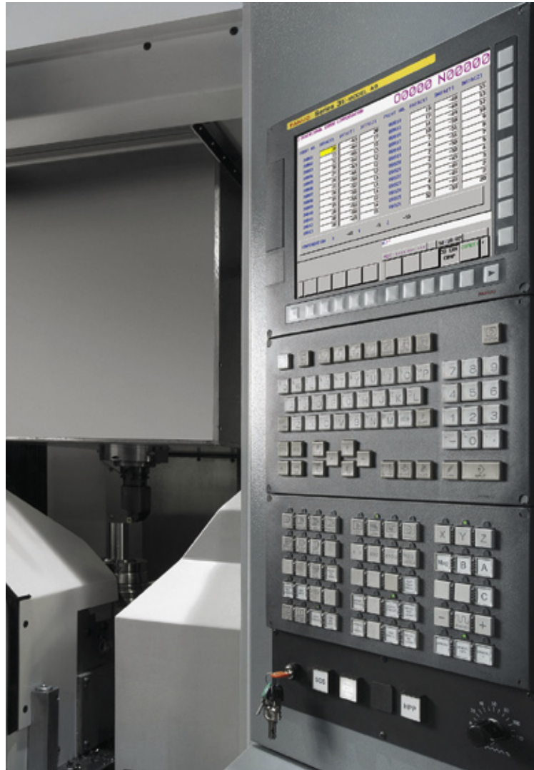
Die in den Fanuc CNC-Steuerungen der Serien 30i und 31i-5 verfügbare Funktion «3D Error Compensation» korrigiert geometrische Maschinenfehler und sorgt für eine grundsätzlich höhere Bearbeitungsgenauigkeit.
