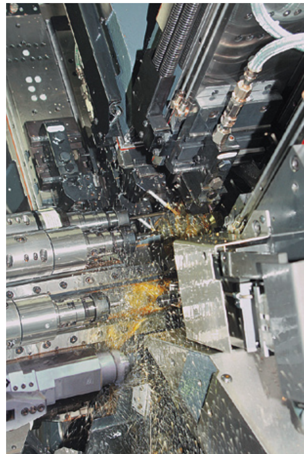
Dem Serienbearbeiter sind alle Funktionen willkommen, die ihn beim Erstellen eines zeitoptimierten NC-Programms unterstützen. Besonders für Mehrspindeldrehautomaten und andere komplexe Maschinen ist die Funktion Path Table Operation (PTO) interessant, die Fanuc in den High-end-CNC-Steuerungen der Serien 30i und 31i zur Verfügung stellt. Bild: Tornos
