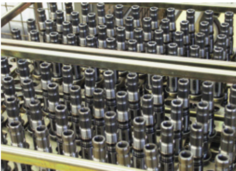
In der Grossserienfertigung spielt die optimierte Bearbeitung eine wichtige Rolle – wie etwa bei diesen Drehschiebern.
