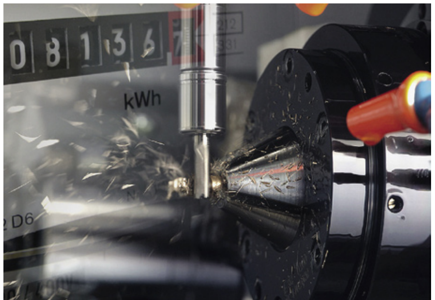
Energieverbrauch unter der Lupe: Die Energie Monitoring Function erlaubt das detaillierte Überwachen der Verbrauchs- und Rückgewinnungswerte aller Achsen während des Bearbeitungsprozesses.
