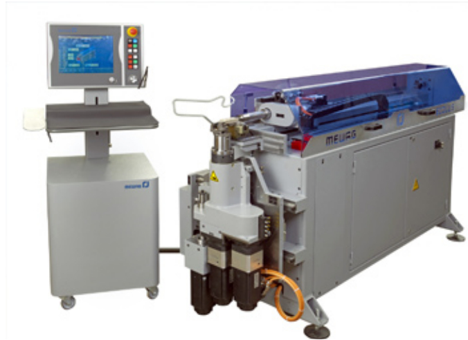
MEWAG: Das Herzstück der Ecolus 15 ist das patentierte Werkzeugsystem. Sechs elektrische CNC-Achsen ermöglichen eine hohe Wiederholgenauigkeit.
