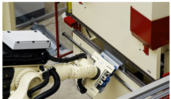
Remmert: ProBend, die Lösung, die aus Industrieroboter, Handlingwerkzeugen und Software besteht, ist in drei, auf unterschiedliche Kundenbedürfnisse ausgerichtete Varianten erhältlich.
