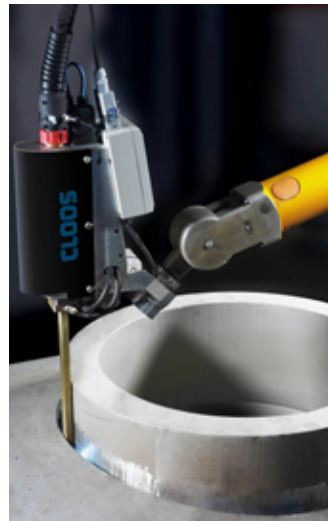
Cloos. Vollautomatisierte Stutzeinschweissung mit der MSG-Engspalttechnik.
