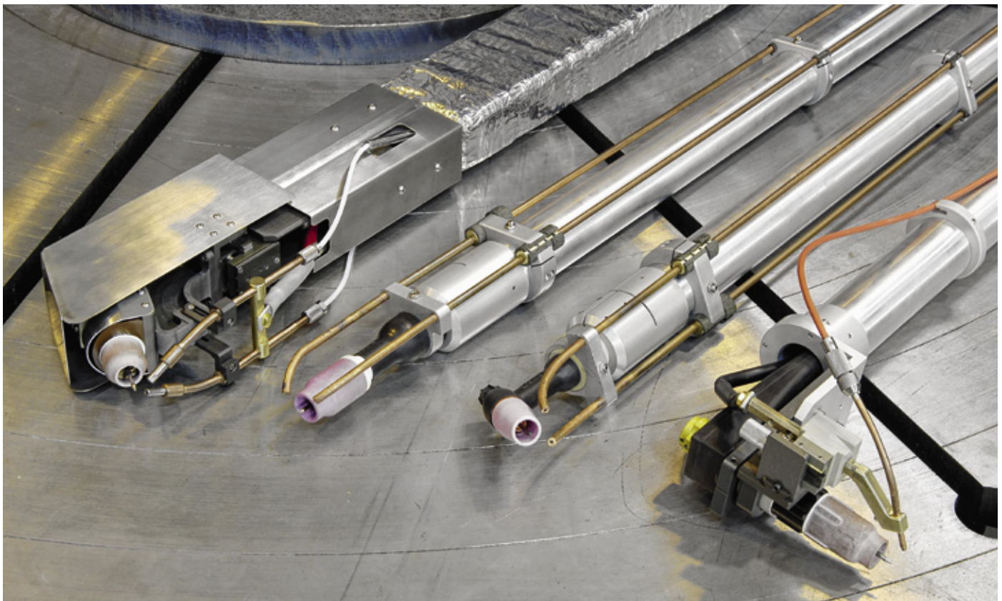
Brenner für das Auftragschweißen von Bohrungsinnenwänden, gerade oder abgewinkelte Ausführung (einfache oder doppelte Heissdrahtzuführung), ausgelegt für Schweißstromstärken bis zu 400 A.
