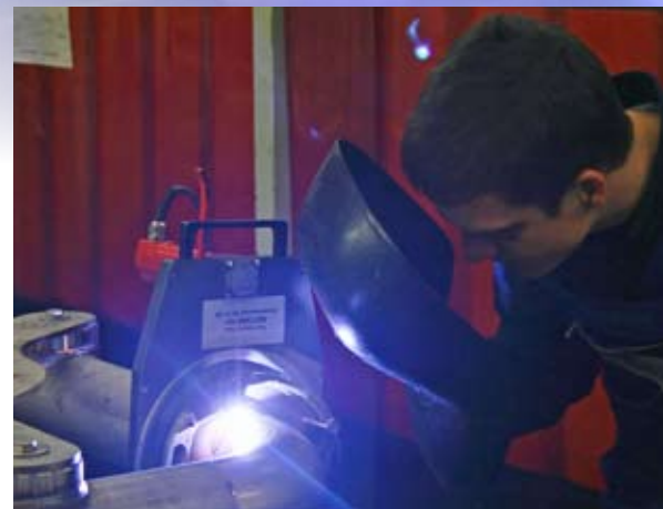
Kompakt und besonders für Rohr-Rohr-Verbindungen mittlerer Wandstärken geeignet – offene Orbital-Schweisszangen vom Typ MU für eine Vielzahl von Edelstahlrohren mit unterschiedlichen Durchmessern. Foto: Polysoude
