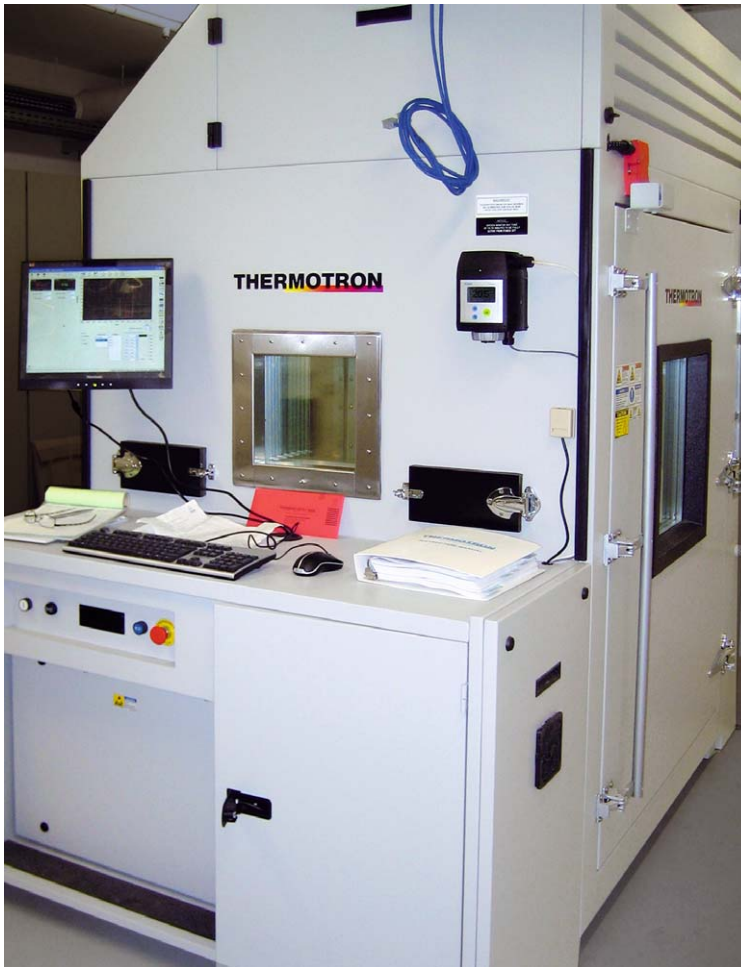
Beim HALT-Test wird der Prüfling in genau definierten Schritten mit immer höheren mechanischen, thermischen sowie kombinierten Belastungen beaufschlagt, bis es zu Ausfällen kommt. Dabei werden zeitgerafft die Funktions- und Zerstörungsgrenzen des Produkts mit dem Ziel ermittelt, die spätere Lebensdauer bis zum Spätausfall erheblich zu verlängern. So verbessert sich die Kenntnis zum Langzeitverhalten und es lässt sich eine höhere Zuverlässigkeit erreichen als durch konventionelle Prüfungen zur Produktqualifizierung innerhalb der Spezifikation (Quelle: Balluff)
